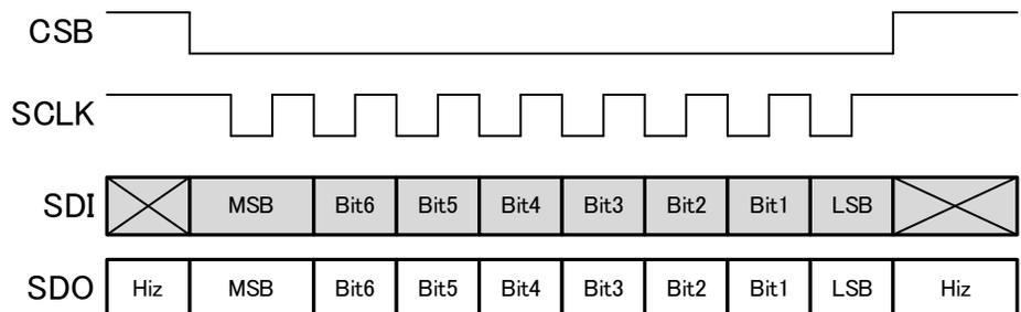
Fig. 19 SPI Waveform
